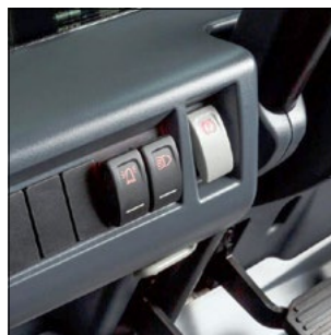
Freno di parcheggio elettrico attivabile tramite pulsante.
