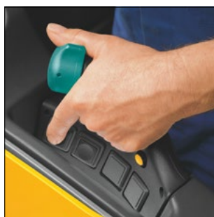
ESE 120: elementi di comando per regolazione di velocità e funzione di sollevamento
